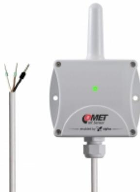
Přístroj měří teplotu z vestavěného vnitřního čidla s možností instalace přímo do měřeného prostoru díky krytí IP65 a také s napětím v rozsahu -30 až +30 V. Pomocí měření s napětím lze na dálku monitorovat např. stav napájecích akumulátorů nebo obecně stav napájení hlídané technologie. Vstup lze rovněž použít pro připojení snímačů nejrůznějších veličin se standardním výstupem např. 0-10 V.
